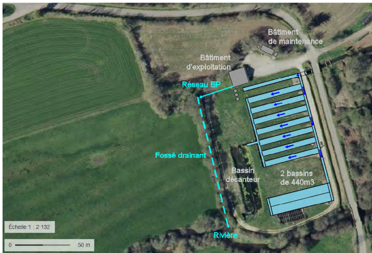
Figure 1-17 : Schéma en vue aérienne du réseau d'eaux pluviales sur la pisciculture existante (source fond de carte : Géoportail)
